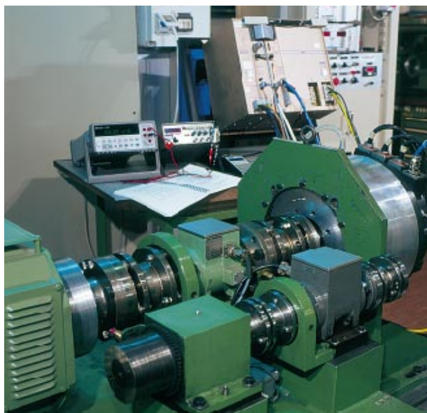
Banco prova 36 kW a 7.000 r/min, 300 Nm
