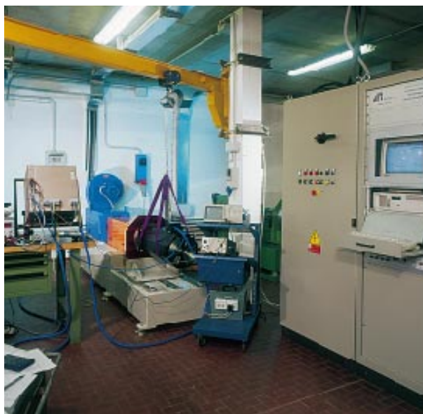
Banco prova 100 kW a 3.000 r/min, 1.500 Nm
