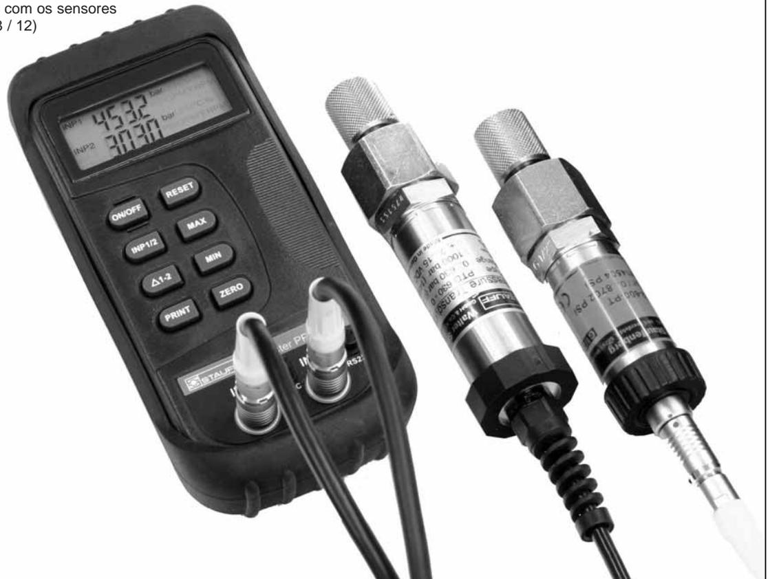
O controle do medidor portátil PPC-04/2 é feito através de 8 botões e facilita ao usuário a obtenção dados sobre a pressão operacional, a pressão de pico, a pressão diferencial, a temperatura, a vazão e a velocidade de rotação.
